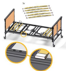
Montage van de houten latten
