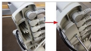
De batterijklep plaatsen – Schroef de batterijklep los of vast met de meegeleverde schroef
